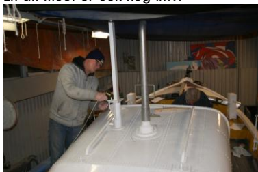
Plaatsing, door René, van de 'nieuwe oude' marifoonmast..
