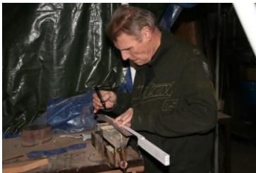
Piet-Chris produceert eigen, koperen montagestrips voor de bekabeling...
