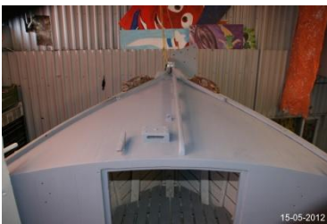
Beslag en handrails gemonteerd...
